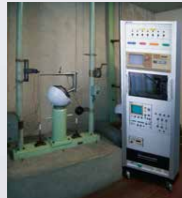
衝撃吸収性試験 (SG認定基準による)
