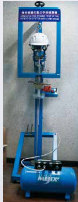
保持装置の強さ試験 (SG認定基準による)
