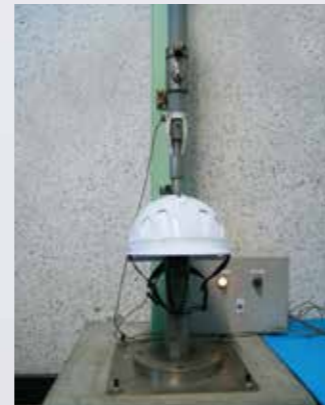
耐貫通性試験 厚生労働省保護帽規格による
